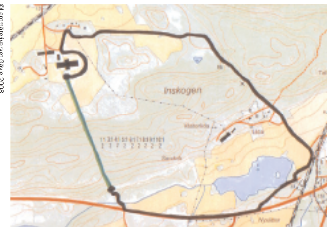
I samband med utökad produktion projekteras på Stenhammar en ny tank för flytgödsel ca 2 km från stallar. Svar t = transportväg för traktor 3,5 km, Grönt = nuvarande pumpledning ovan mark 850 m.
